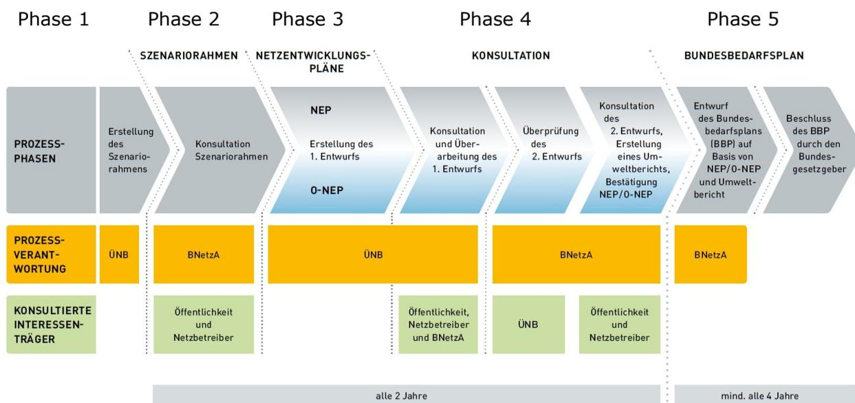
**Abbildung 4.5:** Phasen des Netzausbaus; Quelle BNetzA [4.7.4.3]<sup>1</sup>
