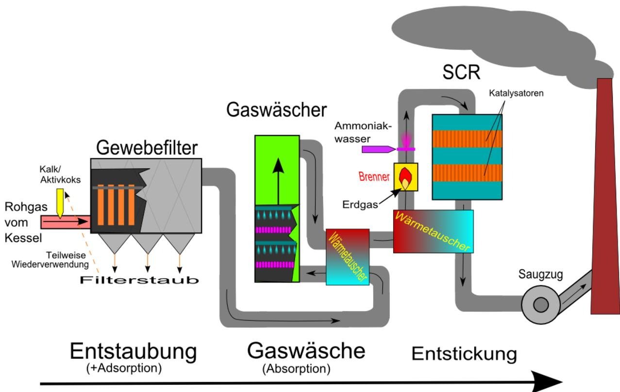
**Abbildung 3.4:** Müllverbrennungsanlage in prinzipieller Darstellung; Quelle Wikipedia
