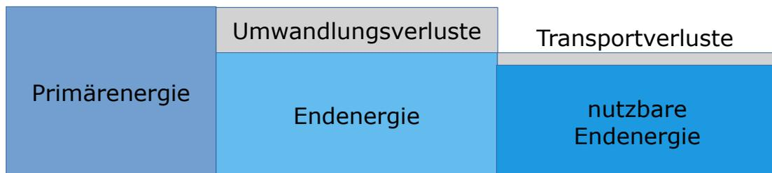
**Abbildung 1.3:** Der Zusammenhang zwischen Primär- und Endenergie
