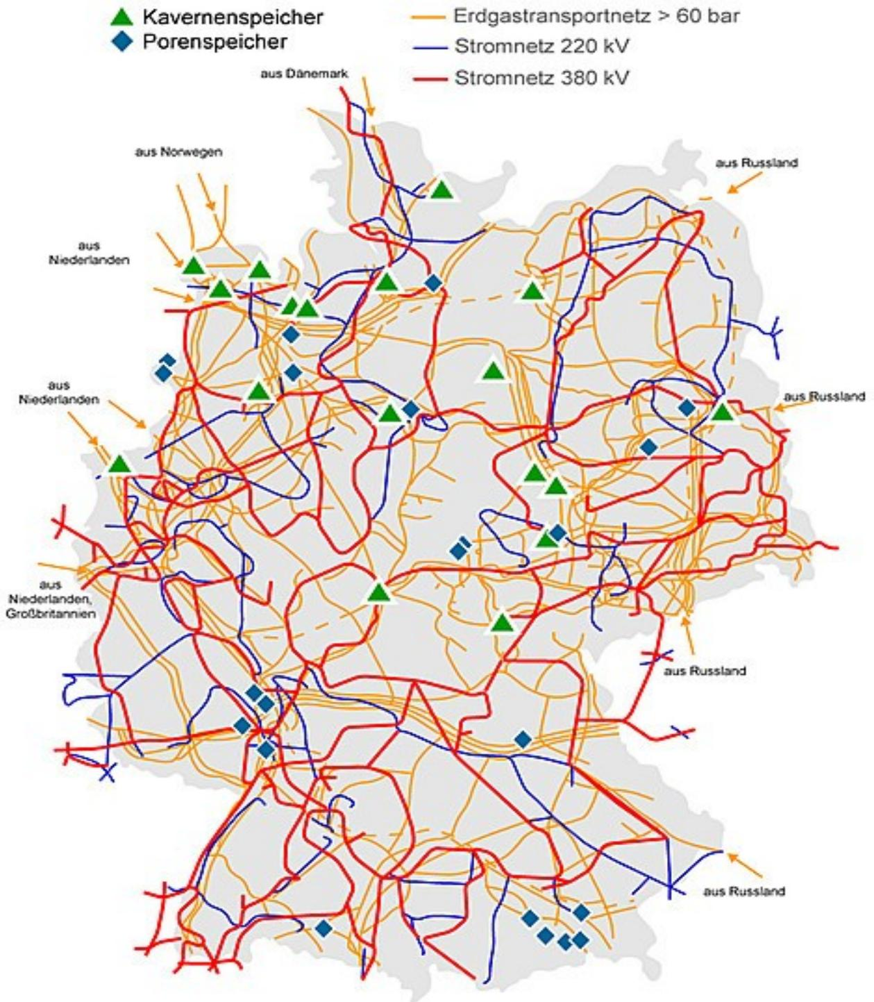
**Abbildung 1.6:** Ausbau Strom- und Gasnetz innerhalb Deutschlands und Verbindungen zu den Nachbarländern [1.7.1.2]<sup>1</sup>
