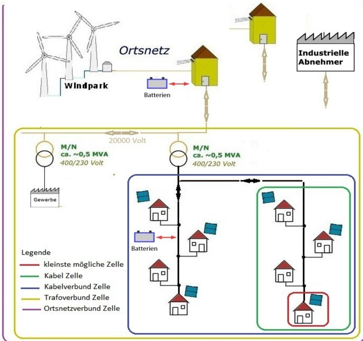
Abbildung 4.4: Zellularer Ansatz bis Ortsnetzverbund – Zelle
