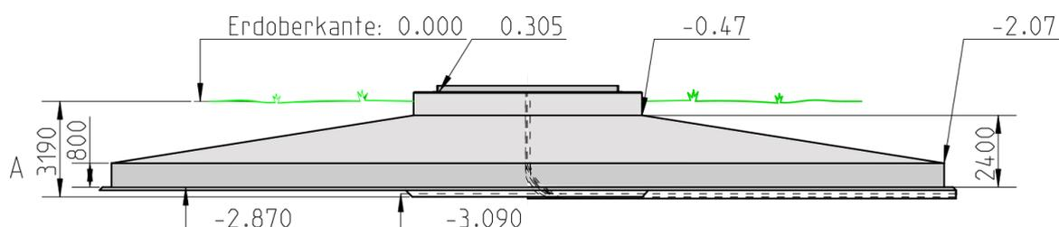
**Abbildung 3.7:** Fundament einer Windkraftanlage
