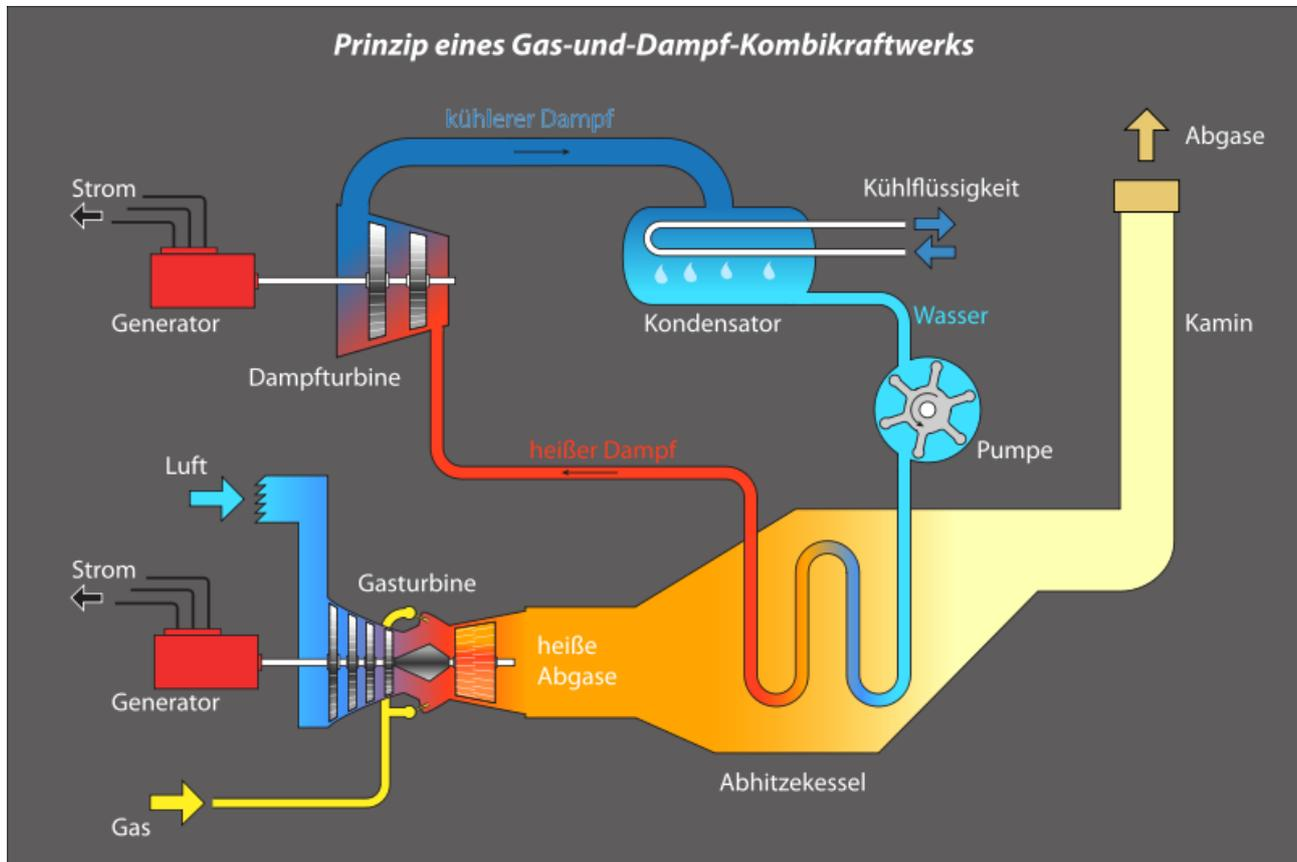
**Abbildung 3.10:** Schema eines GuD-Kraftwerkes; Quelle Wikipedia
