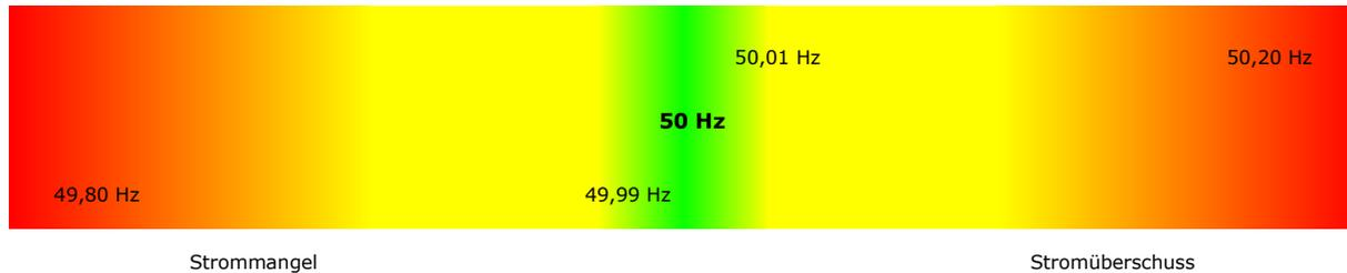
**Abbildung 1.14:** Der enge Normbereich der Frequenz eines stabilen Netzes
