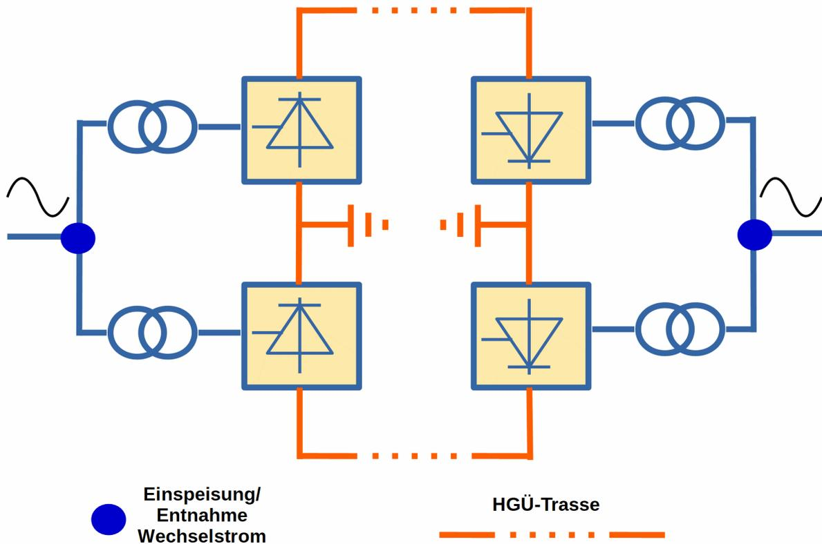
Abbildung 1.8: Wandlung von Wechselstrom in Gleichstrom und zurück.
