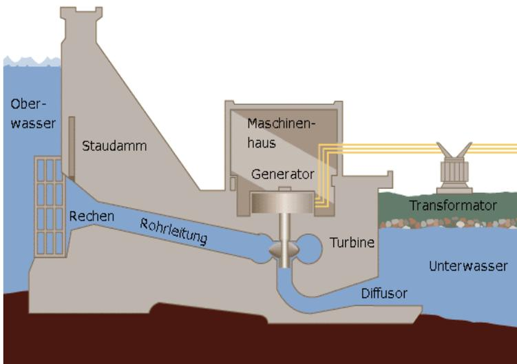
**Abbildung 3.1:** Schemazeichnung eines Laufwasserkraftwerkes; Quelle Wikipedia
