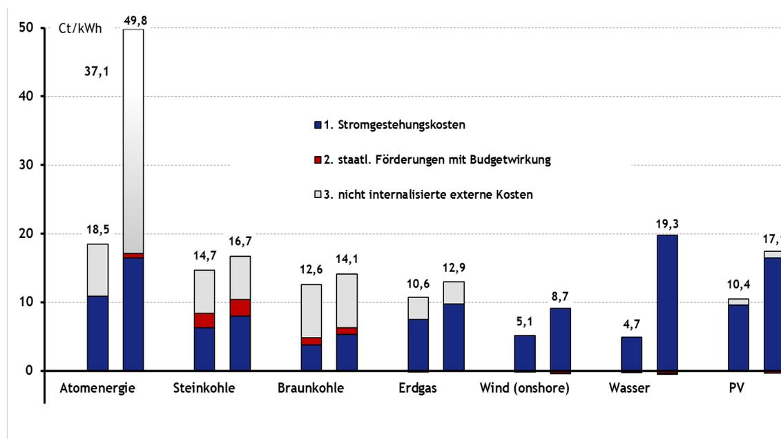
**Abbildung 4.2:** Tatsächliche Kosten der Stromerzeugung aus verschiedenen Energieträgern; linker Balken minimale, rechter Balken maximale; Quelle [4.3.4]
