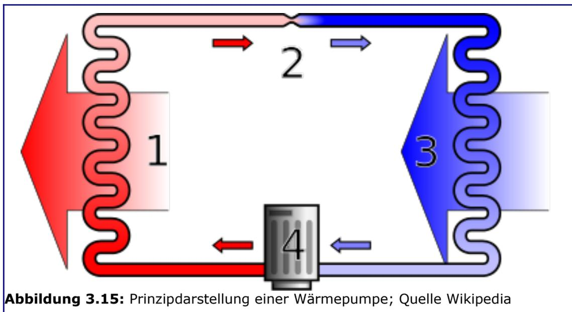
**Abbildung 3.15:** Prinzipdarstellung einer Wärmepumpe; Quelle Wikipedia
