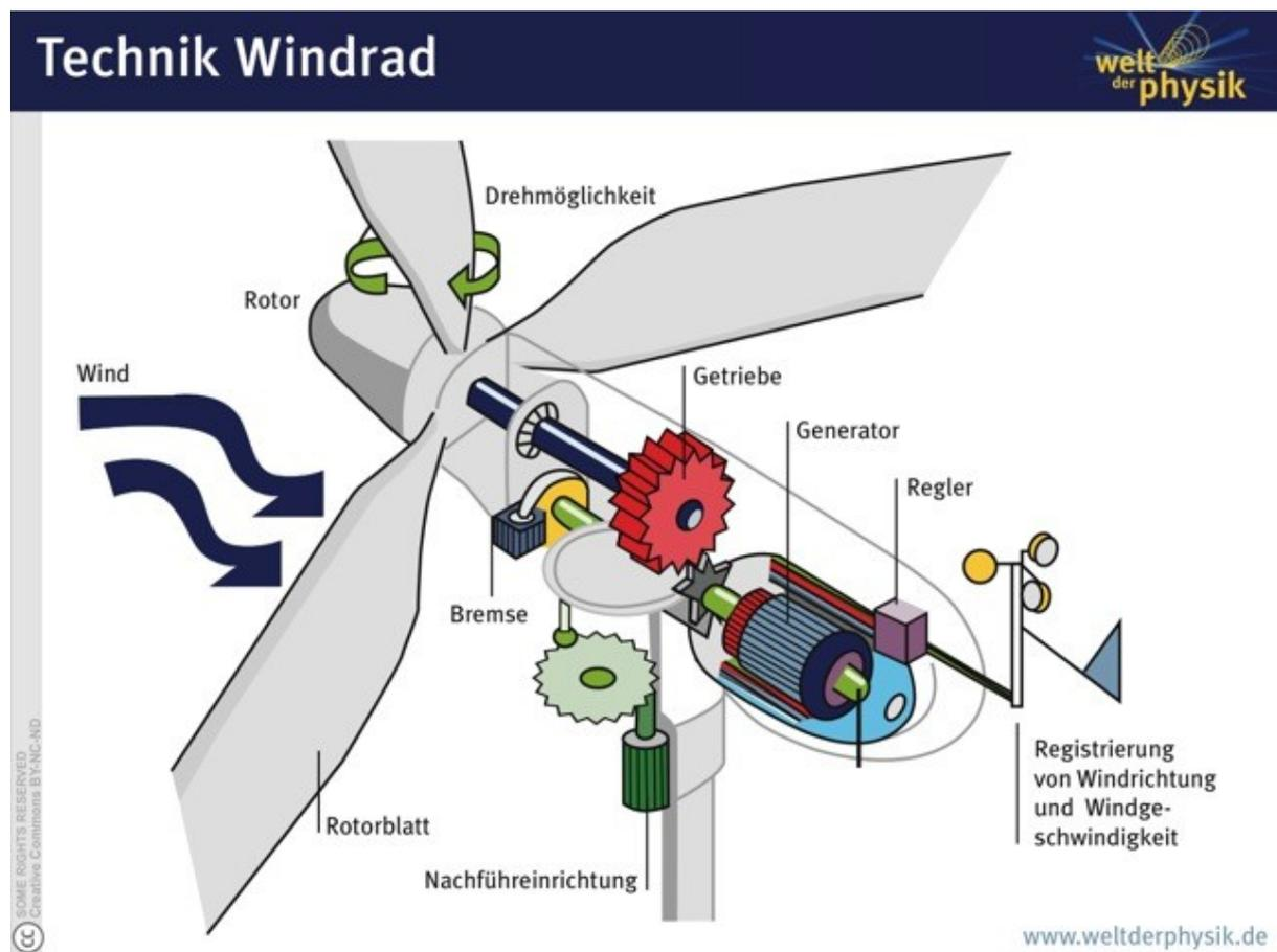
**Abbildung 3.6:** Prinzipieller Aufbau einer modernen Windkraftanlage;
