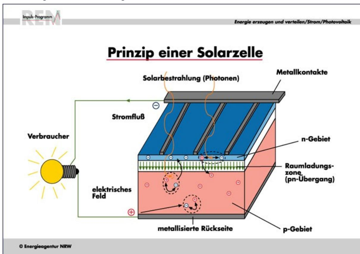
**Abbildung 3.8:** Prinzip einer Solarzelle; Quelle Sotech GmbH
