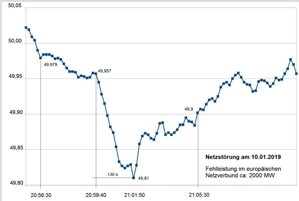
**Abbildung 1.15:** Netzfrequenz des europäischen Verbundnetzes am Abend des 10. Januar 2019
