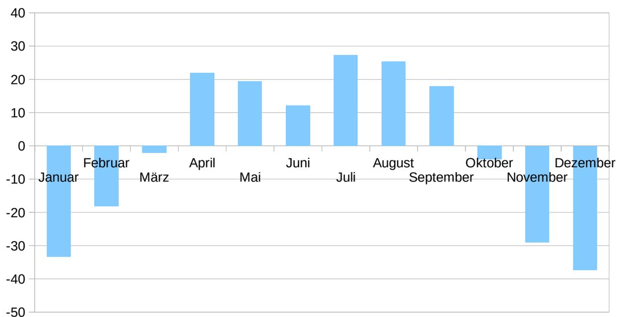
**Abbildung 3.14:** Monatlicher Speicherbedarf für Bereitstellung/Aufnahme von Elektroenergie 2050
