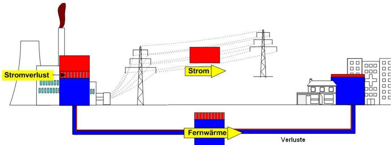
**Abbildung 1.7:** Schema Kraft-Wärme-Kopplung; Quelle Wikipedia
