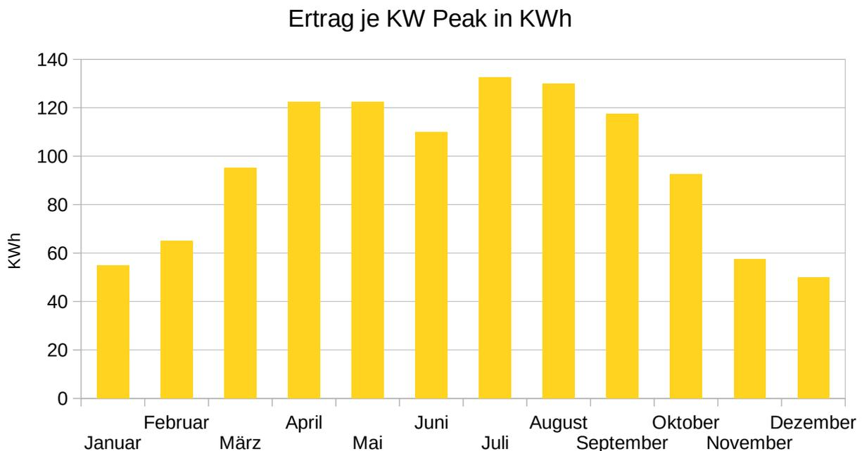
**Abbildung 3.11:** Monatliche Erträge je kWP installierter Leistung in kWh als über Solarrechner ermittelter 5 Jahresdurchschnitt in Deutschland
