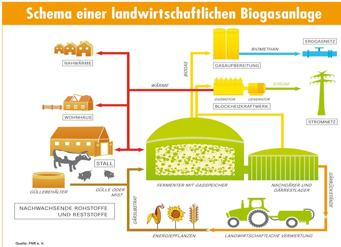
**Abbildung 3.5:** Schema einer landwirtschaftlichen Biogasanlage
