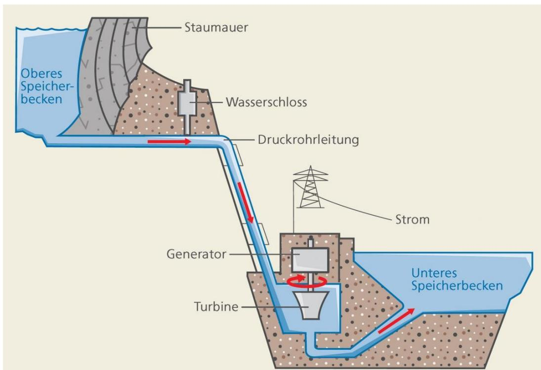
**Abbildung 3.3:** Funktionsprinzip eines Pumpspeicherkraftwerkes; Quelle <http://www.energie-macht-schule.de/content/pumpspeicherkraftwerk-0>
